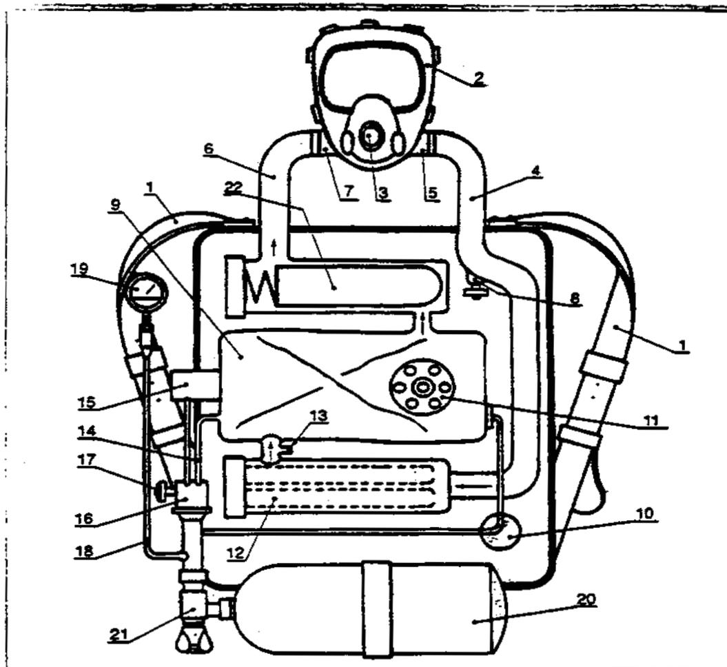
Il gas di respirazione espirato dall'utilizzatore, attraverso la valvola e il tubo espiratori, passa dal facciale nella cartuccia di rigenerazione dove l'anidride carbonica ( $\text{CO}_2$ ) in esso presente viene fissata chimicamente. Il calore generato durante questa reazione fa aumentare la temperatura del gas di respirazione; ciò può venire contrastato con l'uso di dispositivi refrigeranti. Il gas di respirazione purificato fluisce nel sacco polmone.
