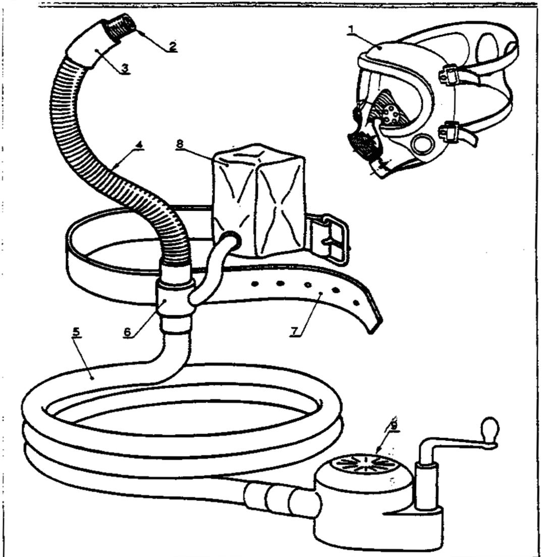
Questo apparecchio consente all'utilizzatore di essere rifornito di aria non inquinata che, per mezzo di un dispositivo di ventilazione azionato manualmente, viene forzata in un tubo per l'alimentazione con aria a bassa pressione. In caso di emergenza l'utilizzatore ha la possibilità di inspirare anche se il dispositivo di ventilazione non è in funzione. L'aria espirata defluisce nell'atmosfera ambiente. L'apparecchio comprende una semimaschera, una maschera intera o un boccaglio.
