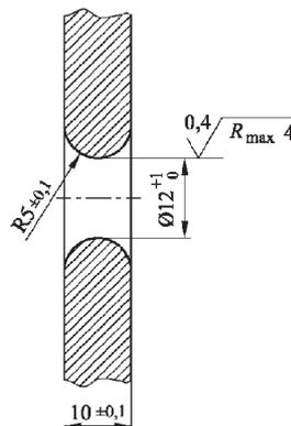
figura 5 Prova di scorrimento della guaina - Taglio a misura del campione
