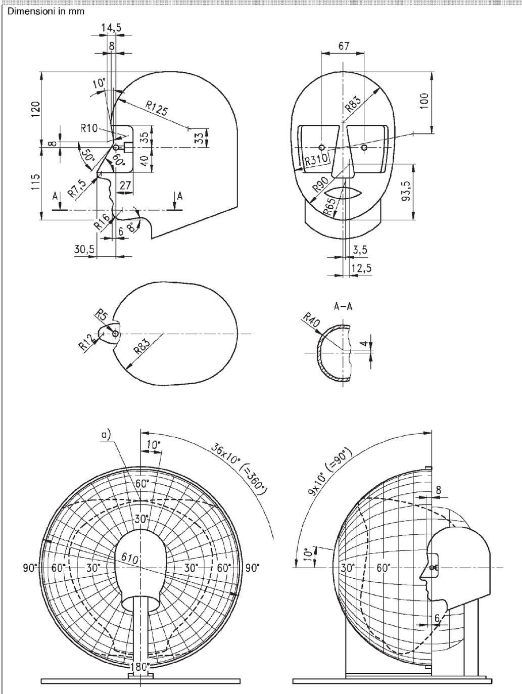
figura 15 Diagramma dell'apertometro
