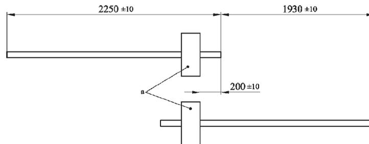
5.4.4.3 Rilasciare le piastre mobili dalla loro posizione di blocco, applicare una forza di  $(50 \pm 0,5)$  N al campione attraverso ciascuna delle tre piastre mobili e tirarlo attraverso l'apparecchiatura a una velocità di  $(0,5 \pm 0,2)$  m/s per una distanza di  $(1\ 930 \pm 10)$  mm.
