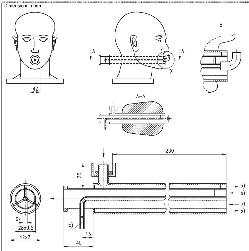
figura 7 Configurazione per la prova del tenore di anidride carbonica dell'aria di inspirazione
