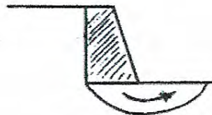
Figura 15.15 - Muro di sostegno: Verifica della capacità portante
