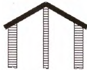
Figura 12.9 - spinta eliminata dal muro di spina
