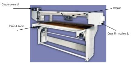
La levigatrice a nastro orizzontale è costituita da una robusta incastellatura in acciaio elettrosaldato sulla quale sono montati gli alberi e le pulegge per la rotazione del nastro abrasivo.
