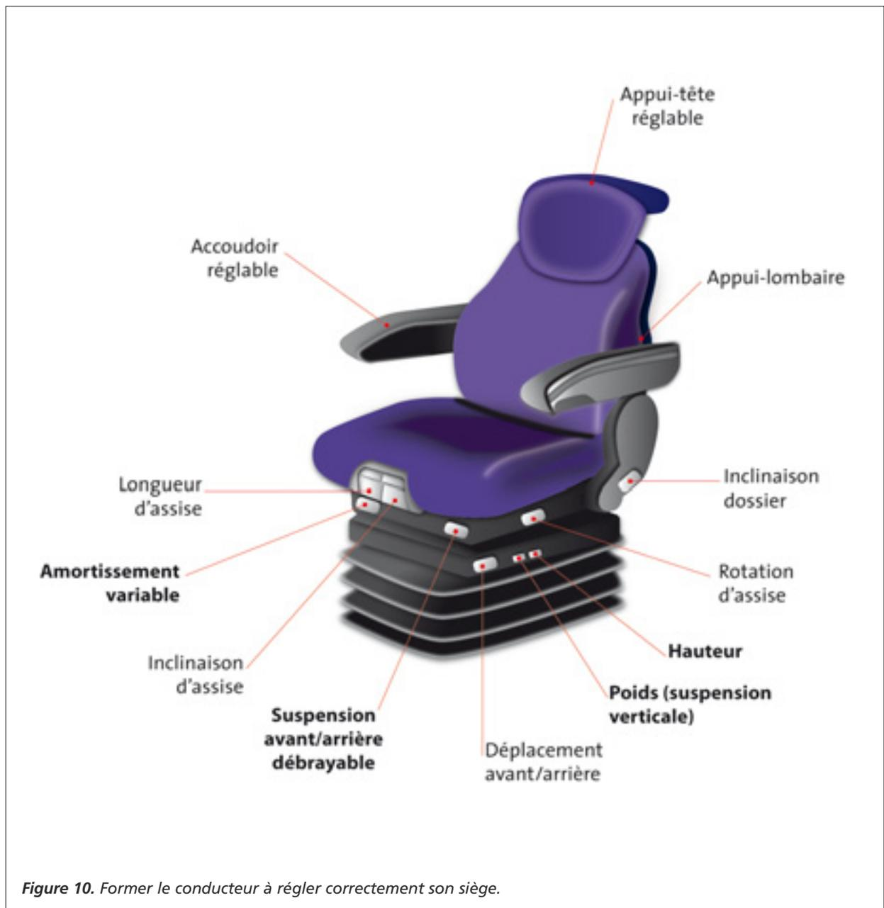
Figure 10. Former le conducteur à régler correctement son siège.
