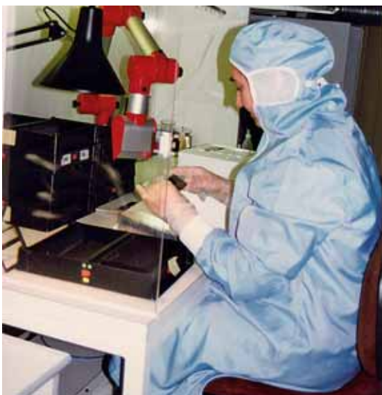
Figura 12: in presenza di allergeni (l'immagine mostra un lavoratore che usa una resina epossidica) l'ambiente di lavoro deve essere pulito e bisogna adottare adeguate misure di protezione.
