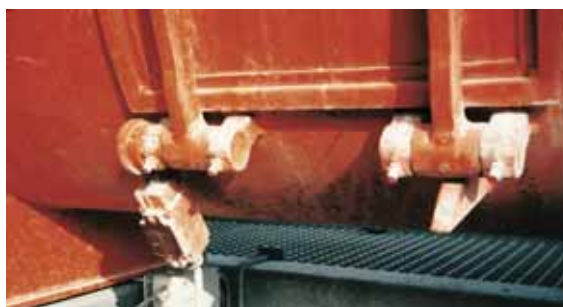
Figura 9 Mentre l'operatore solleva il coperchio, il movimento pericoloso del miscelatore si arresta automaticamente (misura tecnica).
