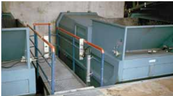
Figura 45 La benna è accessibile da entrambi i lati e facilita l'agganciamento e sganciamento dei cavi.
