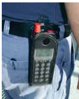
Figura 51 Telefono con dispositivo di segnalazione d'emergenza integrato. È indispensabile un sistema d'allarme efficiente.
