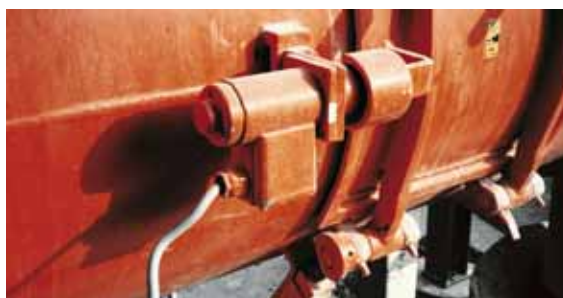
Figura 10 Il coperchio è bloccato meccanicamente in posizione chiusa per impedire che una persona possa introdurre le mani nel rotore in movimento. Un apposito dispositivo di sicurezza (ad esempio un dispositivo di sorveglianza di inattività) garantisce che il coperchio possa essere sollevato soltanto in seguito all'arresto del rotore.
