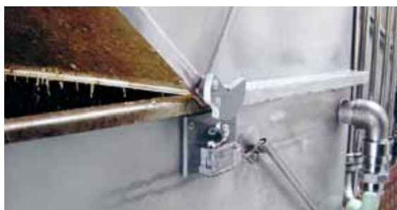
Figura 11 L'interruttore di controllo non può essere azionato se il coperchio è aperto. In questo modo il dispositivo di sicurezza non può essere manomesso.
