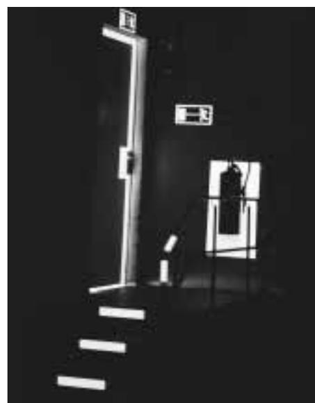
Figura 5: via di fuga segnalata da strisce luminescenti (in condizioni di buio).
