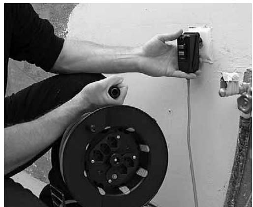
Fig. 4: bobina di cavo con interruttore FI.
