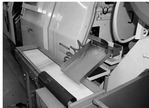
Fig. 3: espulsore pezzi a nastro trasportatore.
