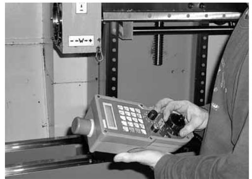
Fig. 6: volantino elettronico (jog) con tasto di arresto di emergenza.
