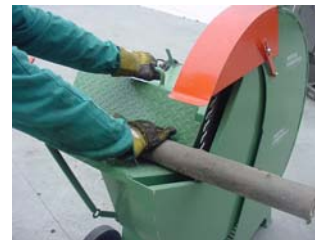
Esempio di protezione lama di una segatrice a disco
