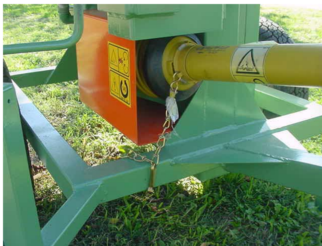
Sistema di trasmissione del moto modificato con albero cardanico protetto, cuffia conforme e catenelle antirotazione
