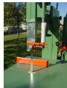
Esempio di protezione lama di una segatrice a nastro
