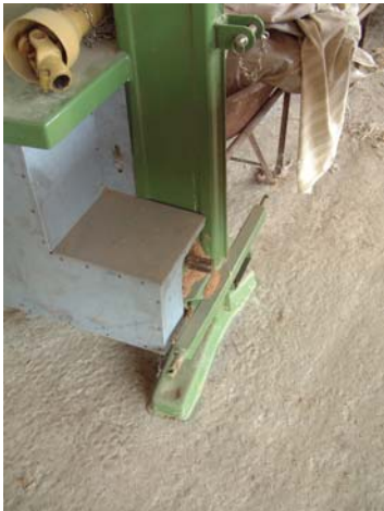
Esempio di albero cardanico non protetto
