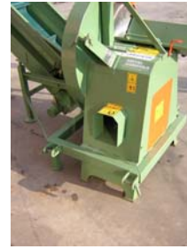
Esempio di protezione cinghie di trasmissione
