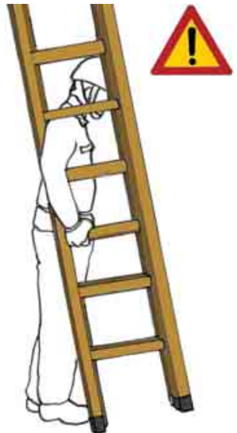
Fig. 6 - Modalità errata di trasporto della scala a spalla
