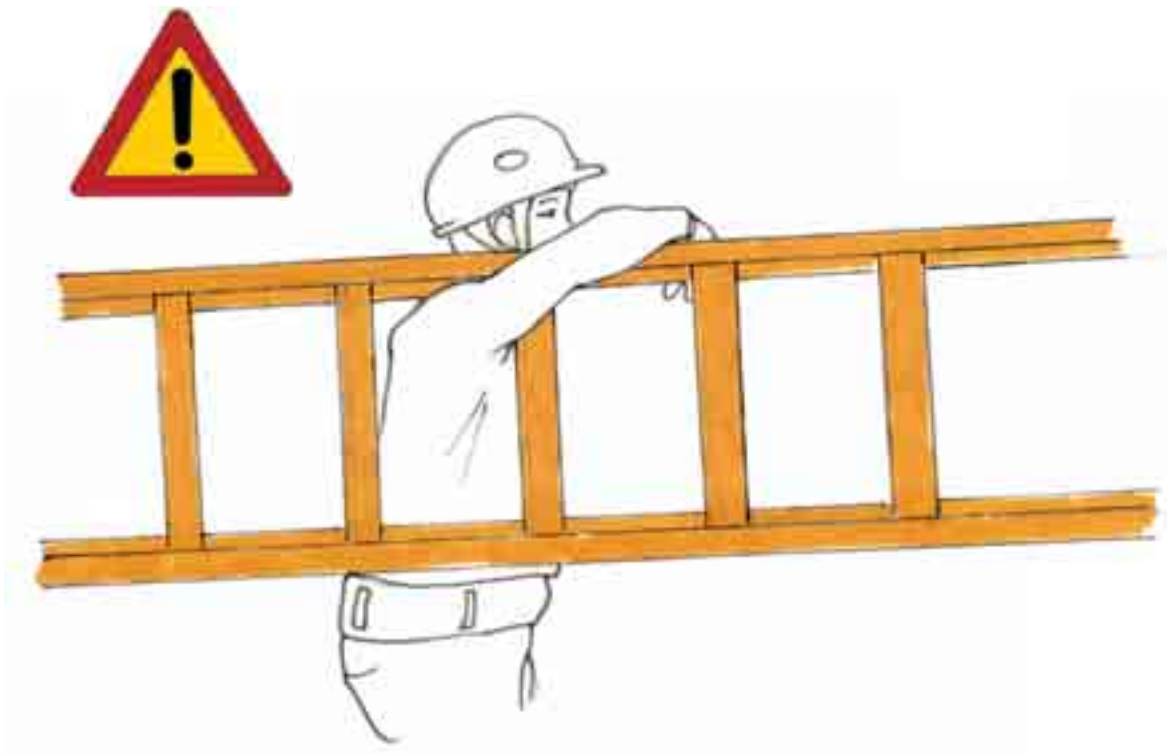
Fig. 22 - Modalità errata di trasporto della scala a spalla
