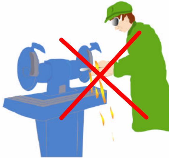
Figura 1. Utilizzo errato della mola
