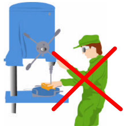
Figura 2. Utilizzo errato del trapano a colonna
