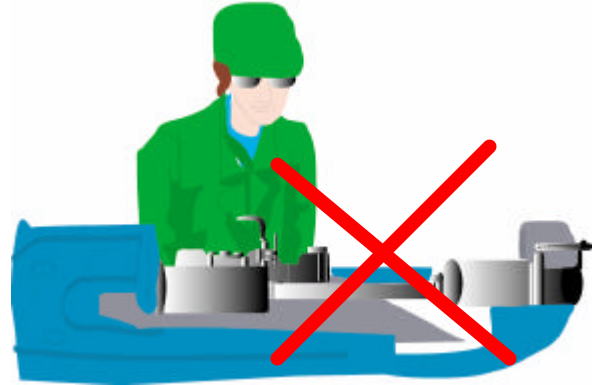
Figura 3. Posizione corretta dell'operatore, ma sono assenti gli schermi di protezione della macchina.
