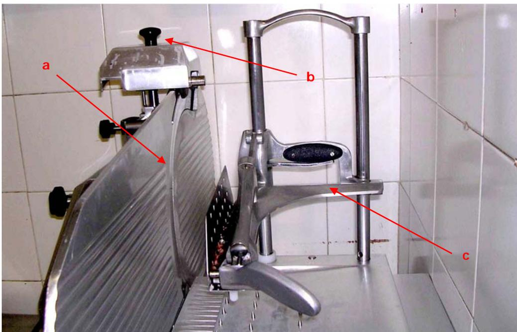
Nell'affettatrice è possibile riconoscere il carter paralama (a), il blocco sull'affilatoio (b) e l'elsa di protezione sull'impugnatura del carrello (c).
