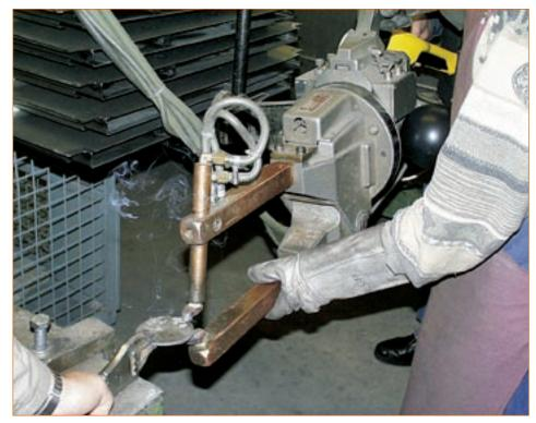
Emission of electromagnetic fields by a spot-welding gun Berufsgenossenschaftliches Institut für Arbeitsschutz, Germany
