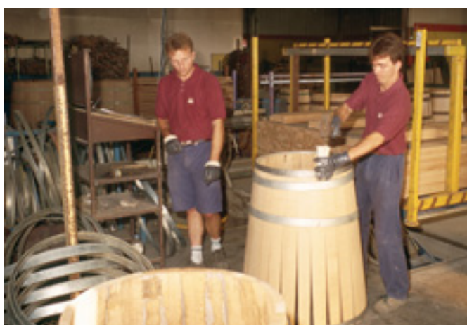
Phase de martelage des cercles sur les tonneaux
