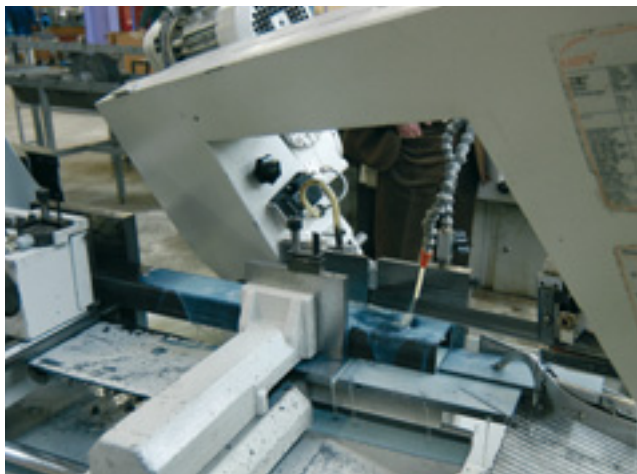
Nouvelle machine en cours de sciage d'un profilé
