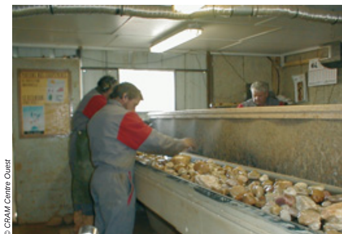
Local avant traitement : les galets triés sont jetés entre les deux tapis
