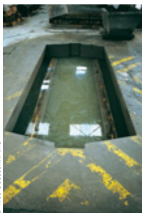
Fosse remplie d'eau prête à recevoir le moule
