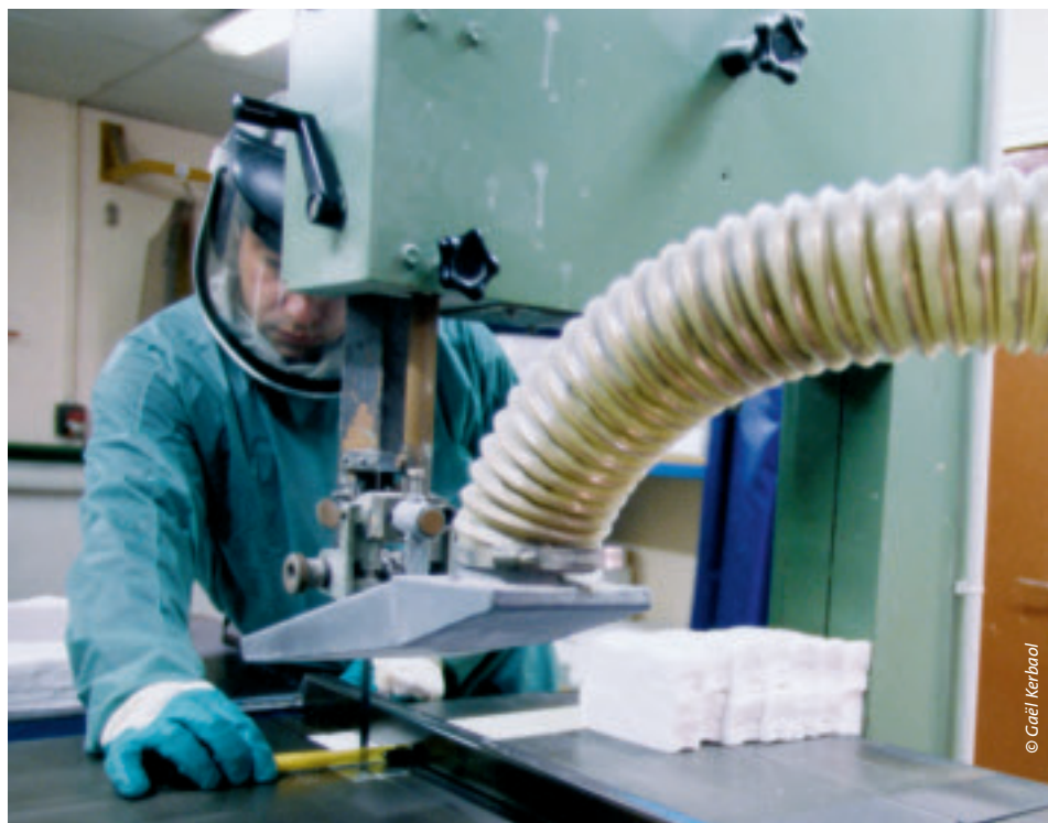
Découpe de pièce en fibres céramiques réfractaires : les mesures de protection collective (aspiration au point d'émission notamment) doivent être complétées par le port de protections individuelles (gants, masque, combinaison, lunettes).
