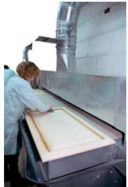
Une solution bien adaptée au ponçage : la table aspirante
