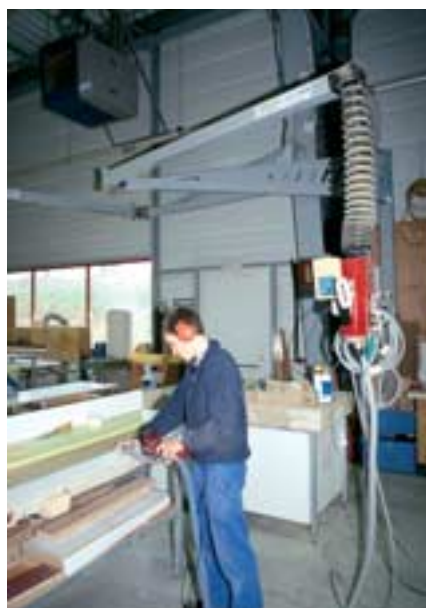
Les machines portatives doivent être équipées d'une aspiration intégrée raccordée à un système spécifique à haute dépression
