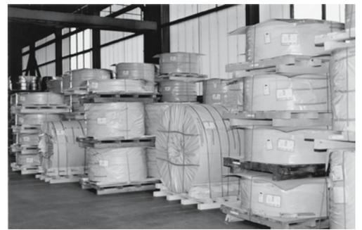
Figura 5: le merci di forma cilindrica possono essere accatastate solo verticalmente o su palette speciali.
