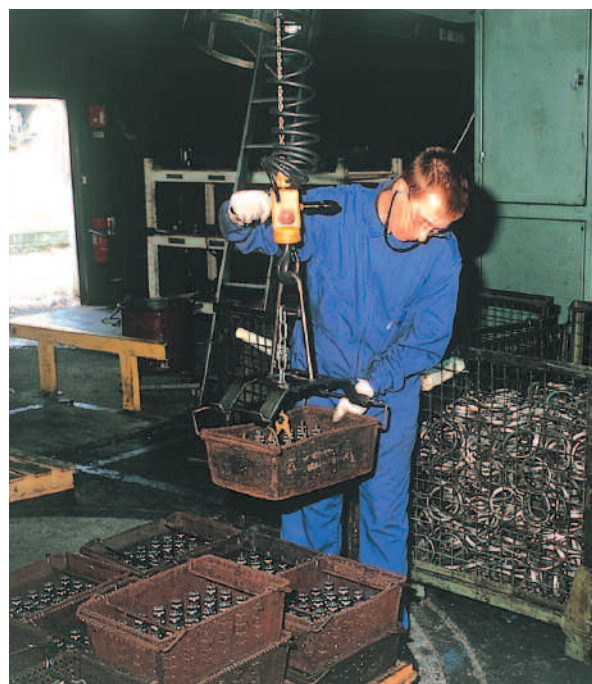
Utilisation d'un palan pour la manipulation des paniers
