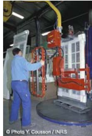
© Photo Y. Cousson / INRS Outil de préhension pneumatique permettant la manipulation de portes et de fenêtres
