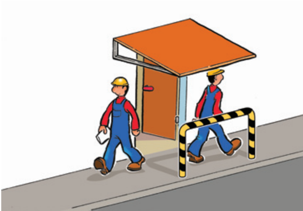
Barriera fissa conformata ad archetto ed evidenziata con bande trasversali oblique gialle e nere intervallate, a protezione della zona antistante una porta pedonale
