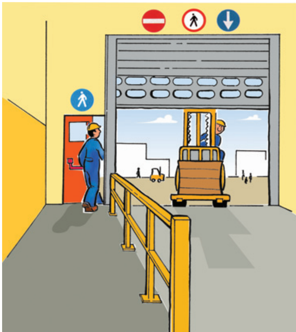
Barriera di protezione tra il percorso ed il passaggio pedonale e quello destinato ai carrelli, in corrispondenza di un'uscita di reparto
