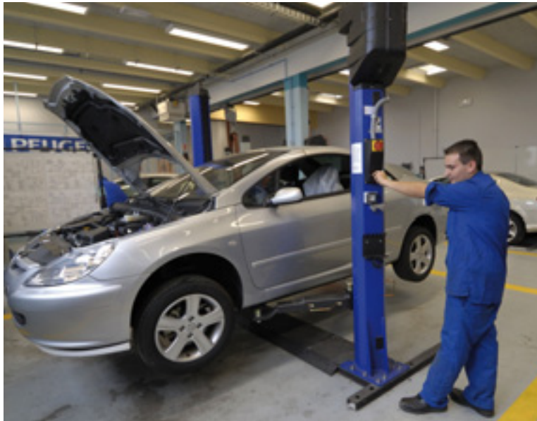
20. Pont élévateur à 2 colonnes à bras pivotants. Les consignes d'utilisation sont inscrites en un endroit parfaitement visible du pont (près de la commande)
