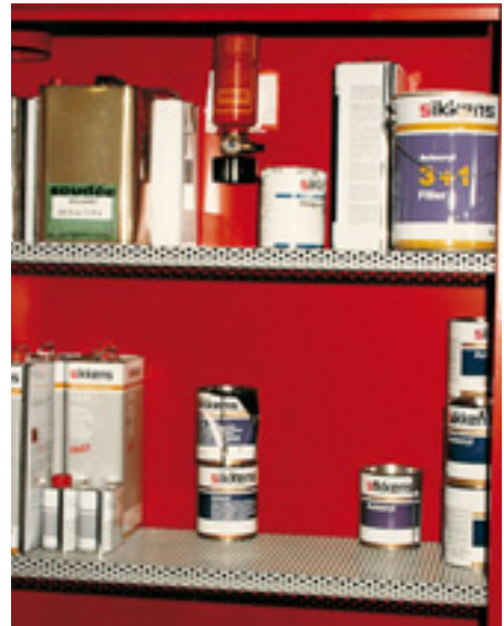
10. Armoire anti-feu ventilée pour un stockage peu important de produits inflammables
