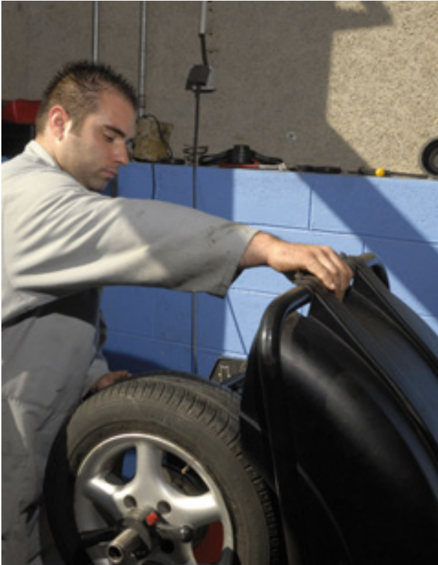
25. Après montage de la roue, l'opérateur doit remettre en place le protecteur pour faire fonctionner la machine
