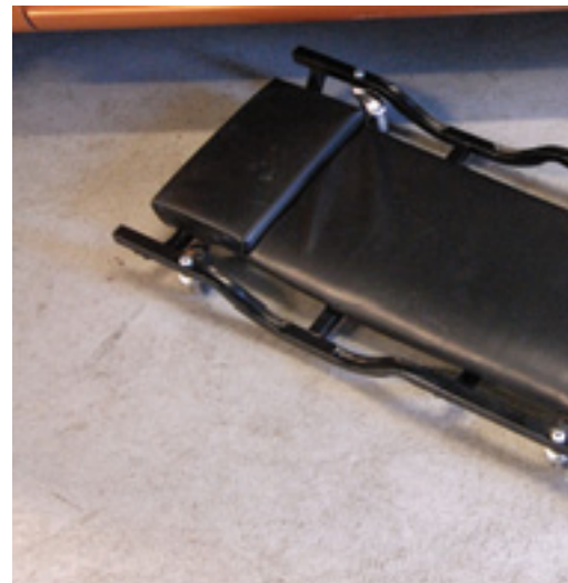
22. Sommier roulant permettant de travailler sous un véhicule
