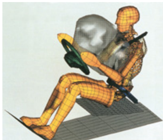
39. Coussin gonflable de sécurité et prétendeur de ceinture (PSA Peugeot Citroën Dir com)
