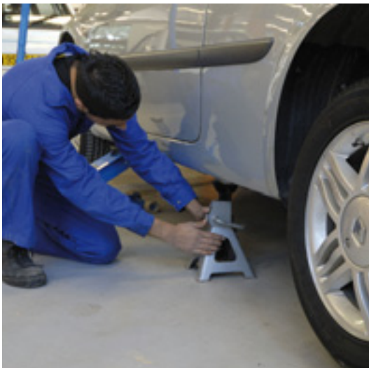
21. Chandelle tripode conçue pour effectuer des calages
