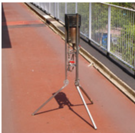
38. Modèle de torçhère : elle permet le brûlage et le dégazage des réservoirs avant toute intervention sur le véhicule équipé de GPL (© CFBP)
