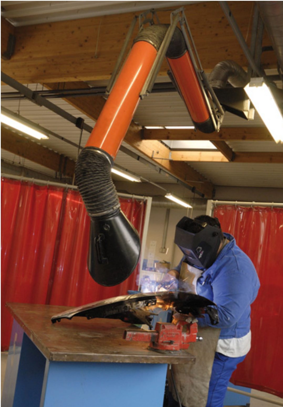
29. Poste de soudage équipé d'une buse mobile d'aspiration des fumées
