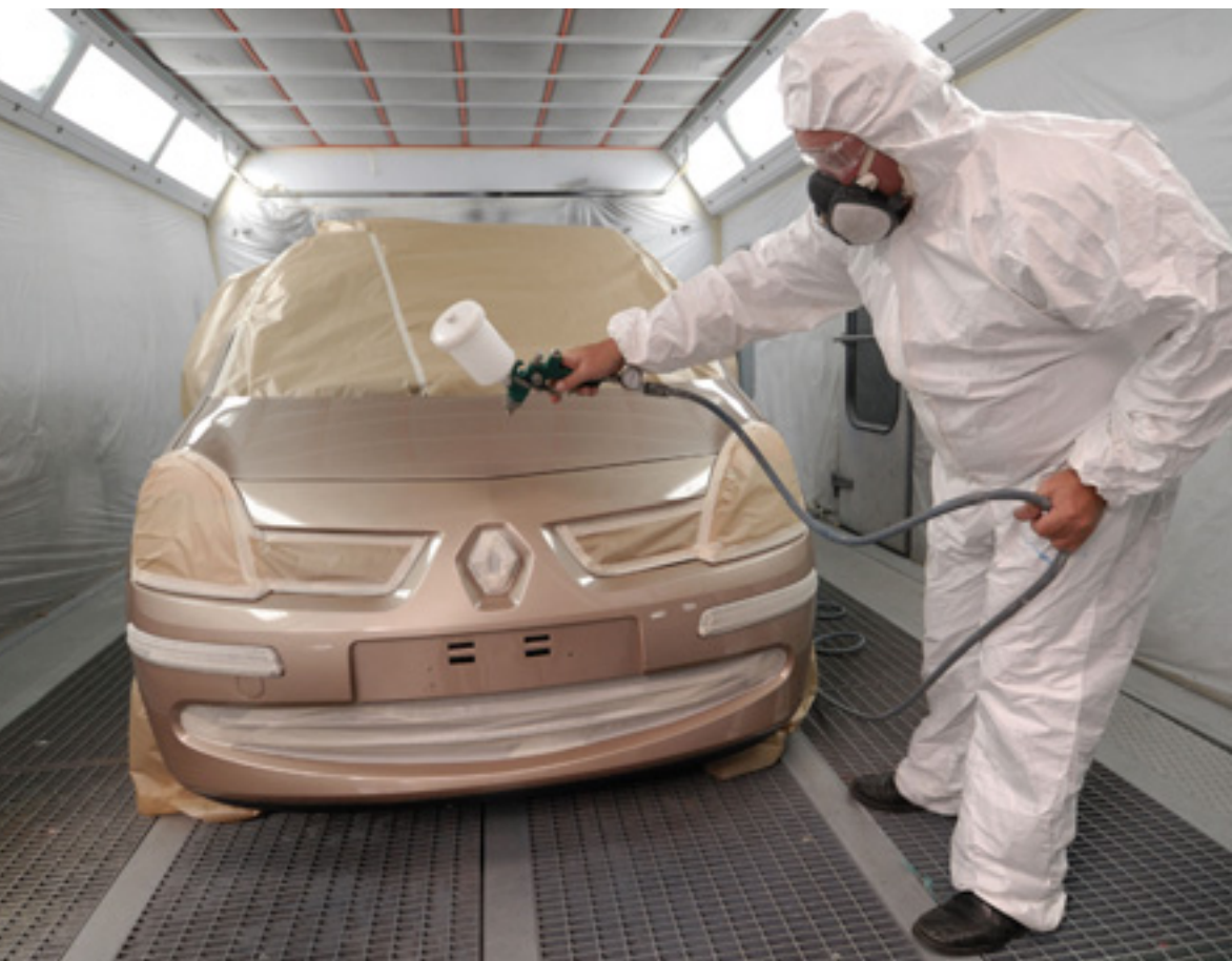
35. Travaux de peinture dans une cabine ventilée
