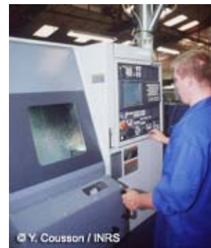
Insonorisation par encoffrement d'un tour à commande numérique
