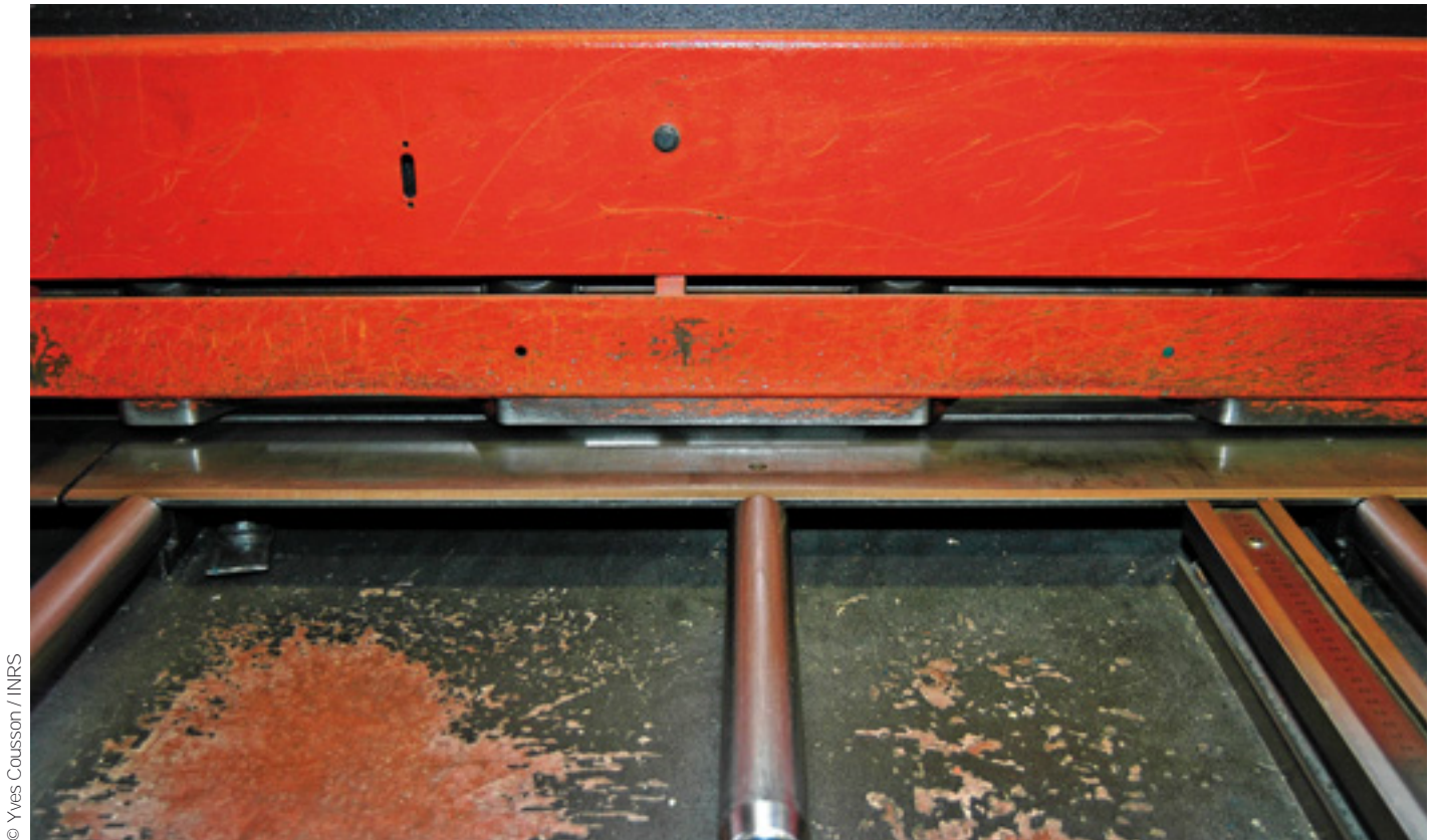
Fig 4. Protège-doigts non rectiligne.
