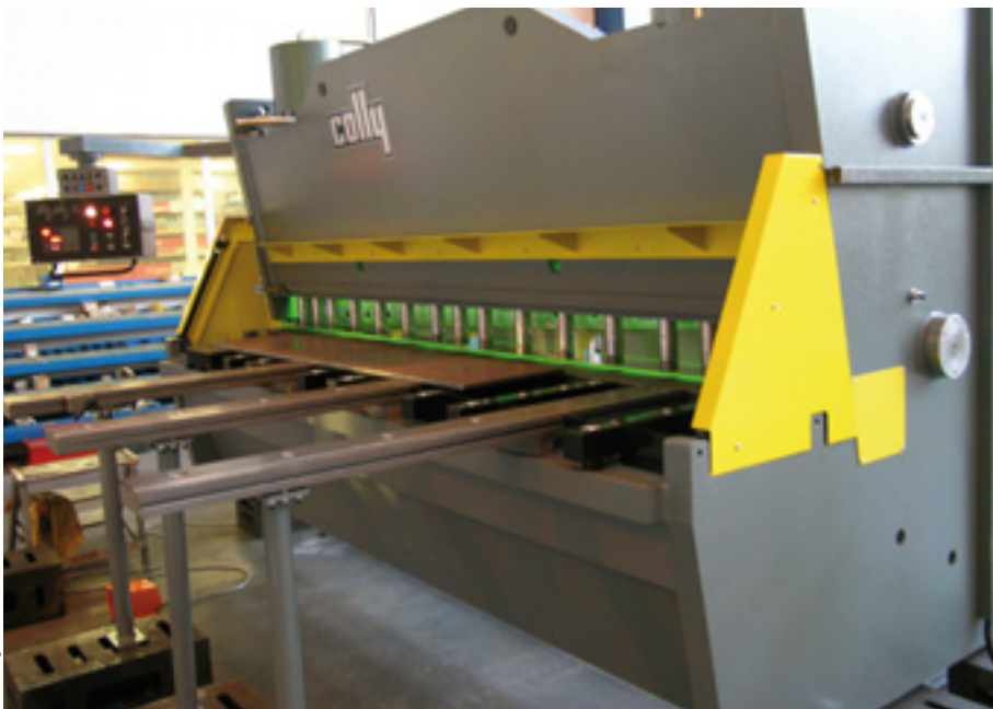
Fig. 5. Exemple de barrière immatérielle installée sur une machine neuve.
