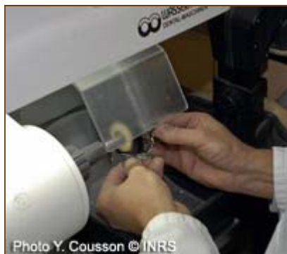
Usinage d'une prothèse dentaire sous aspiration
