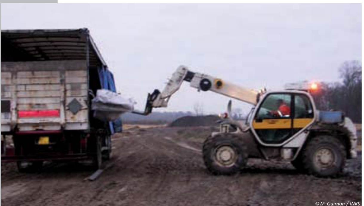
Déchargement de plaques d'amiante-ciment à l'aide d'un engin manutention à cabine pressurisée
