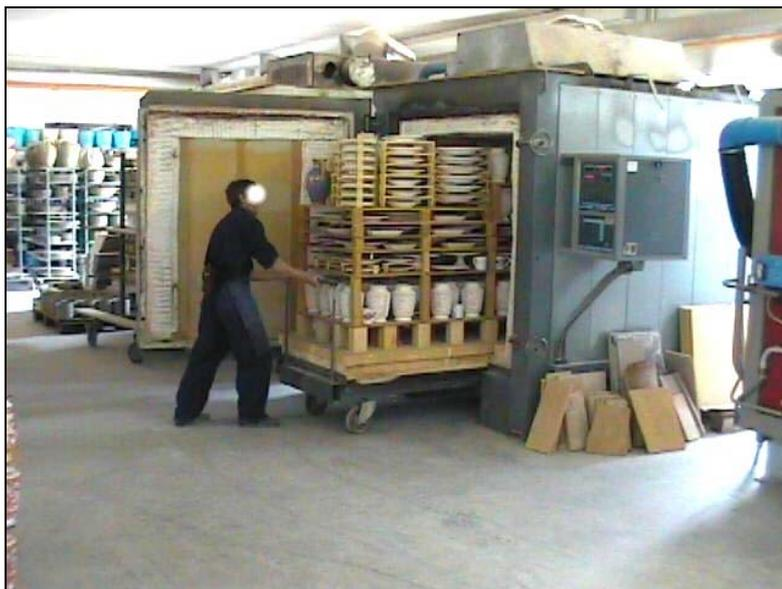
**Foto 30: estrazione del carrello dal forno dopo la cottura. La coibentazione del forno, in questo caso, prevede "a vista" in parte laterizi refrattari, in parte materassini di FCR (bianchi nella foto)**
