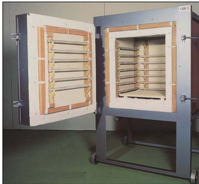
**Foto 10: forno elettrico da 250 litri, coibentato con fibre ceramiche refrattarie**
