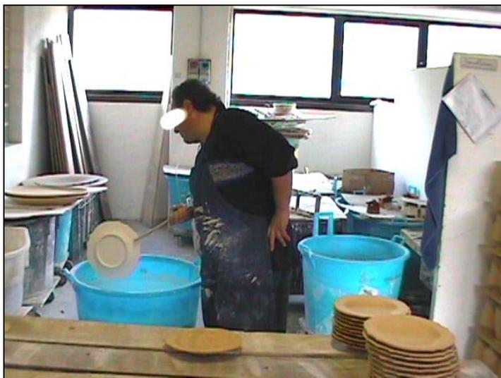
Foto 13: smaltatura per immersione del biscotto, con l'impiego di pinze
