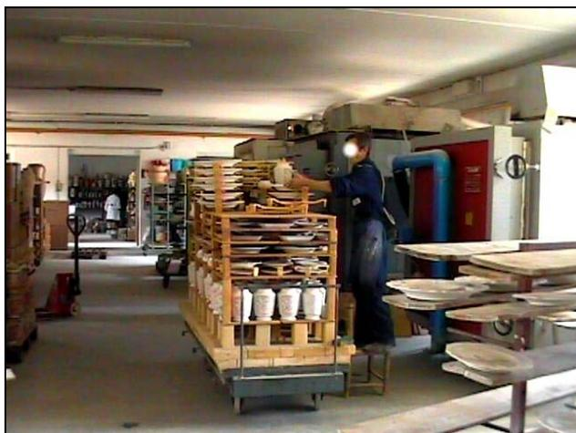
**Foto 28: carico del carrello del forno: l'operatore impiega uno sgabello per raggiungere i punti più alti del carico**
