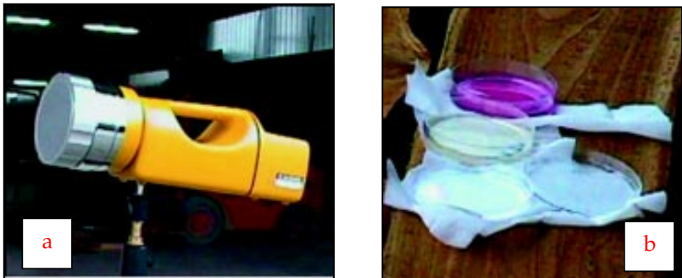
Figura 3.2: a) campionatore ad impatto ortogonale SAS; b) piastre per il campionamento passivo IMA.
