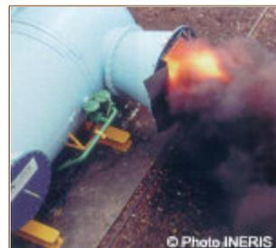
*Event : dispositif de décharge de la pression d'explosion*
