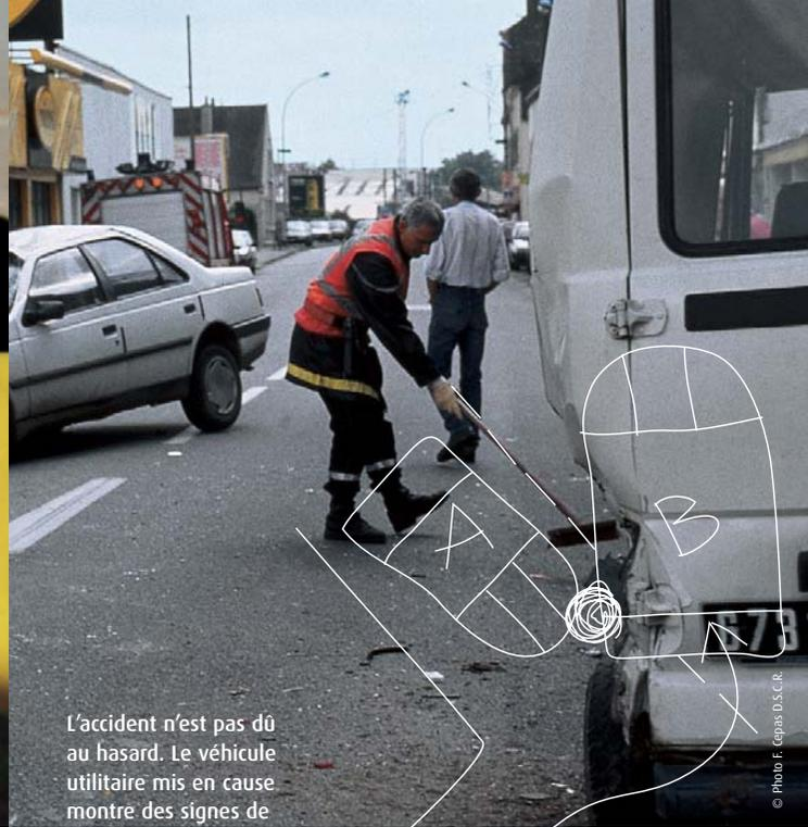
L'accident n'est pas dû au hasard. Le véhicule utilitaire mis en cause montre des signes de mauvaise maintenance : feux clignotants cassés, pneus usagés et freins défectueux.
