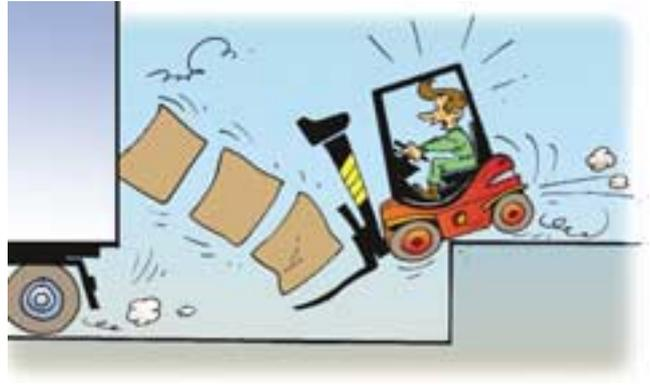
Le chariot bascule latéralement de la rampe sur laquelle il circule.
