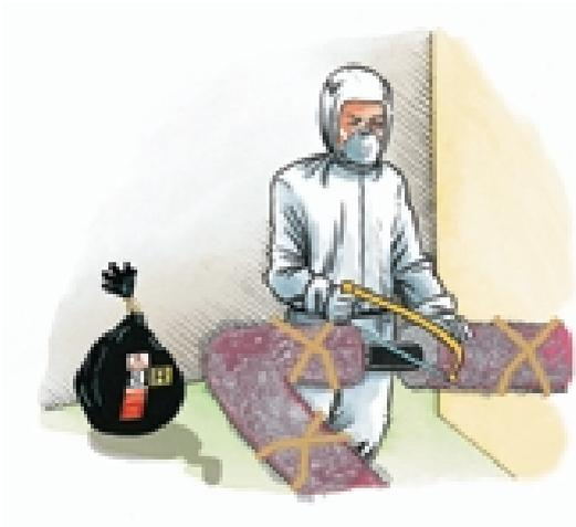
Prima di tagliare un tubo ricoperto con isolanti di amianto è necessario incapsularlo e proteggerlo adeguatamente con fogli di polietilene. Rimuovere preliminarmente nella zona di taglio l'amianto con la tecnica di glovebags.
