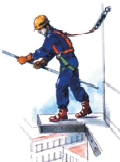
Esempio di sistema anticaduta con imbracatura - fune di sospensione - dissipatore - ancoraggio
