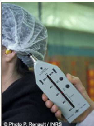
Le sonomètre doit être utilisé à hauteur d'oreille
