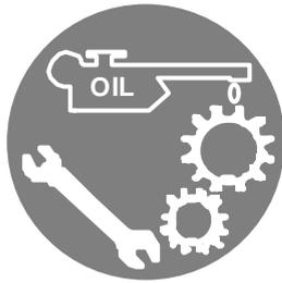
Tutte le operazioni di manutenzione, quali ingrassaggio, lubrificazione o sostituzione di organi lavoranti, devono essere effettuate con la macchina appoggiata a terra, la presa di potenza disinserita ed il motore della trattrice fermo.
