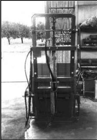
**Rischio:** cesoiamento dovuto allo scorrimento verticale della struttura del cestello.
