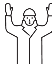
Pericolo – Alt Arresto di emergenza
