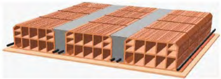
Figura 10.7 – Solaio in laterocemento gettato in opera: assonometria
