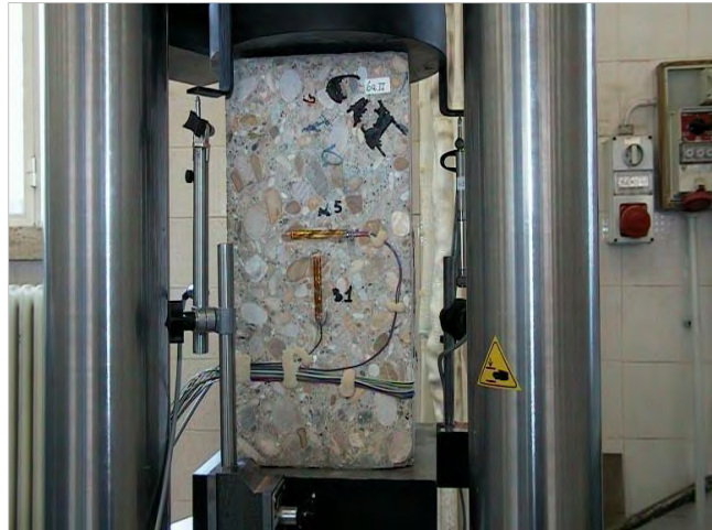
Figura 2.19 Campione di prova sottoposto a compressione
