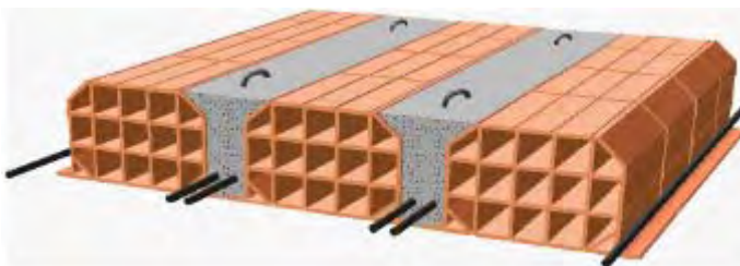
Figura 10.13 – Solai a pannelli prefabbricati
