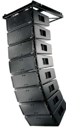
Figura 3. Immagine raffigurante una "Line Array" Questi sistemi di riproduzione sono costituiti da un certo numero di speciali moduli indipendenti (diffusori), sovrapposti verticalmente ed allineati, che operano come una singola sorgente sonora e che, se vengono rispettate alcune condizioni, sommano le loro emissioni in modo coerente (Fonte: SUVA [2]).
