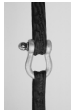
Figura 4: Fasce raccordate correttamente.
