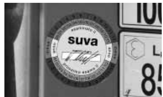
Figura 3: gru controllata a regola d'arte: l'esperto gruista applica sulla gru un adesivo che certifica che il controllo è stato eseguito. La frequenza dei controlli dipende dall'età della gru. Per saperne di più rivolgetevi al vostro esperto di gru o visitate la pagina Internet www.suva.ch/ordinanzasullegru .
