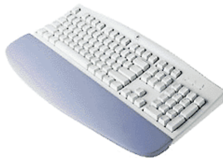
Fig. 95: esempio tastiera dotata di supporto per mani e polsi volto ad agevolare il lavoro del videoterminalista.
