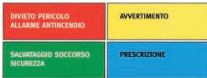
Fig.17: I colori che contraddistinguono i diversi tipi di segnaletica.
