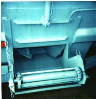
Il sistema di scarico è generalmente costituito da un boccaporto con saracinesca scorrevole, comandata da un cilindro idraulico a doppio effetto e da un trasportatore per lo scarico nella mangiatoia azionato da un motore idraulico. I trasportatori più diffusi sono di 4 tipi: ad una o più coclee, ad elica continua, a nastro trasportatore in gomma, a nastro trasportatore con catene e traverse.
