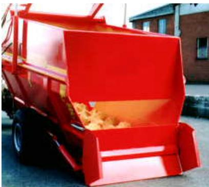
4. L'insilato caduto a fianco del carro, previa disattivazione della presa di potenza e conseguente arresto delle coclee, può essere caricato manualmente nella parte posteriore della tramoggia.
