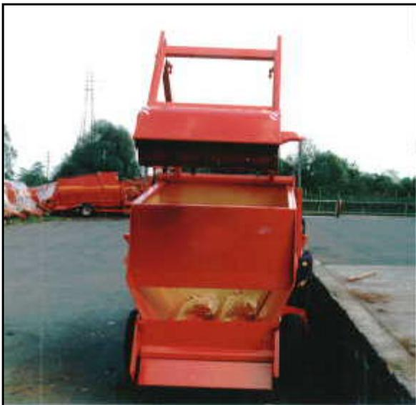
**Ipotesi di soluzione:** se il lato superiore della macchina si trova a più di 1,6 metri da terra, dovrà essere previsto un mezzo di accesso. Quando il controllo è a vista, la distanza fra il bordo superiore del comparto ed il gradino superiore, oppure tra il bordo superiore del comparto ed il terreno non deve essere inferiore a 1,2 metri e non superiore a 1,6 metri. Se queste distanze non sono rispettate è necessario il comando del tipo a "uomo presente" per il movimento delle coclee.
