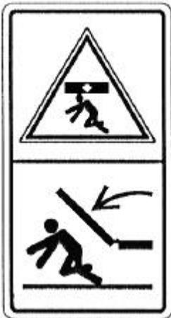
**Rischio:** caduta delle barre irroratrici dalla posizione di trasporto ed erronea attivazione dei comandi di apertura/chiusura e del bloccaggio meccanico.
