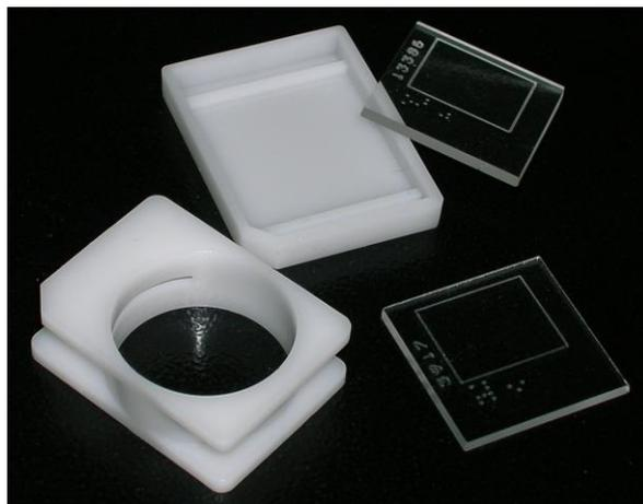
Figura A3.2 - Dosimetro ANPA/ARPA con il rivelatore CR39
