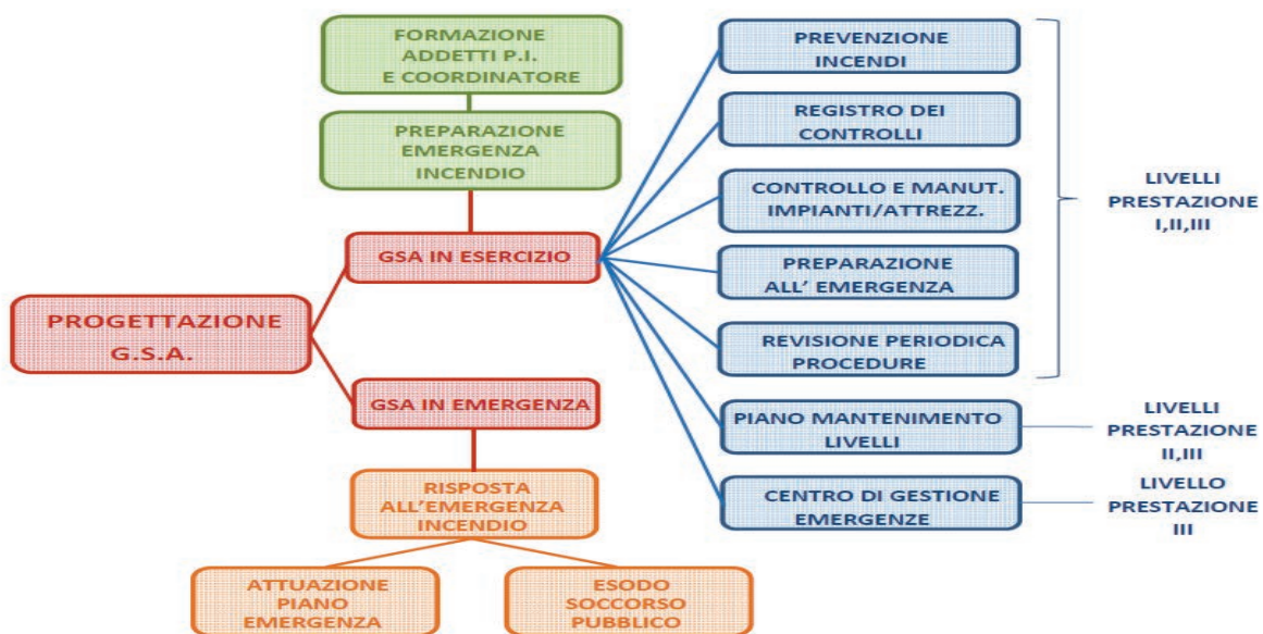
FLOW CHART DELLA GESTIONE DELLA SICUREZZA ANTINCENDIO
